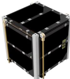
**Quetzal-1 est le premier satellite (de type CubeSat) développé au Guatemala.** Le projet, développé par plus de 100 étudiants, ingénieurs et professeurs d'université issus de l'Université del Valle, vise à tester un **capteur optique pour la détection de chlorophylle** dans les corps d'eau et ainsi solutionner les problèmes de développement de cyanobactéries dans certains points d'eau du pays notamment au lac Atitlan. Le satellite, dont la construction
