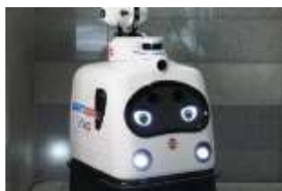
« PatoRo » robot de surveillance de ZMP maintenant équipé de pulvérisateur de solutions désinfectantes
