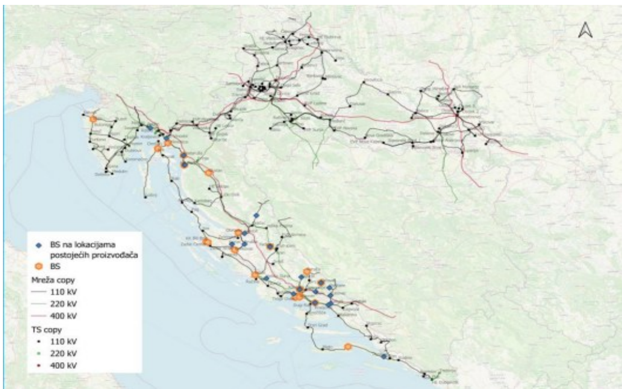
Figure 4 : Répartition des emplacements et des tailles des batteries (BESS) pour le scénario initial
